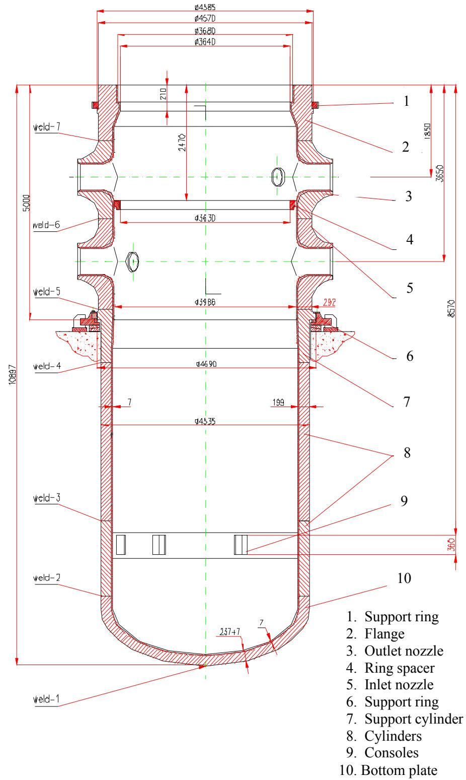
**Figure 3.1.1.3. Core barrel**
